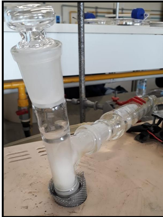
Figura 14 - Fração gasosa obtida com teores intermediários de negro de fumo
