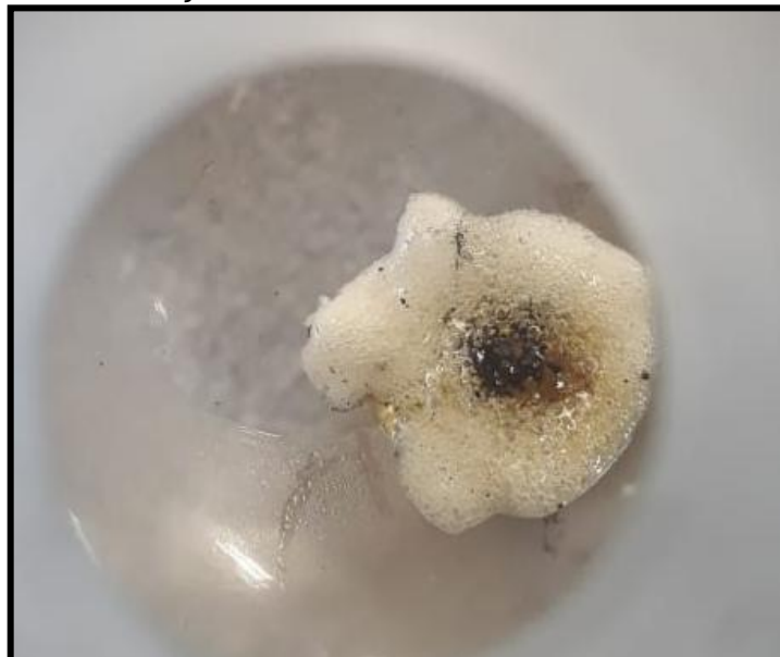
Figura 13 - Fração sólida obtida na amostra EPS/0,0125C
