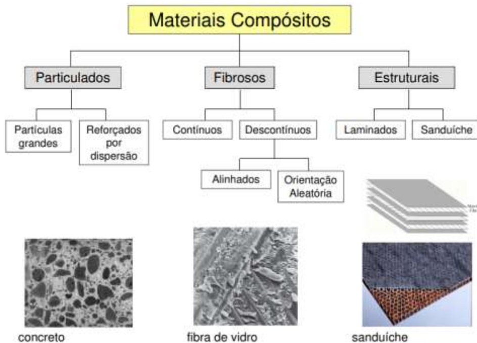
Figura 7 - Classificação dos compósitos na fase dispersa
