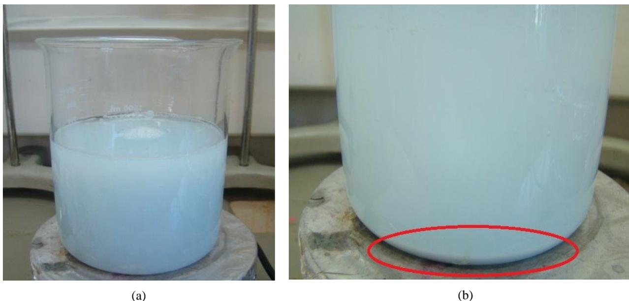
**Figura 20.** Aspecto da solução sintética (a) após tratamento de cloração alcalina e (b) detalhe do lodo galvânico precipitado no fundo do béquer.
