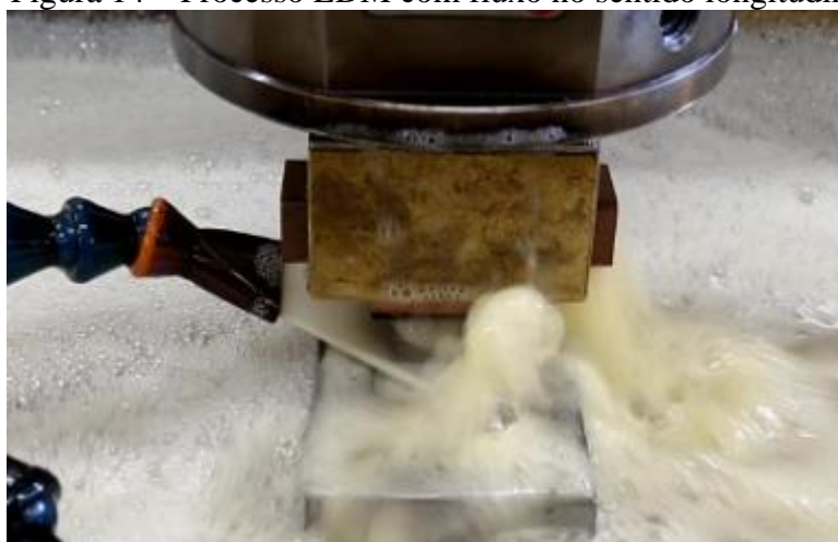
Figura 14 – Processo EDM com fluxo no sentido longitudinal
