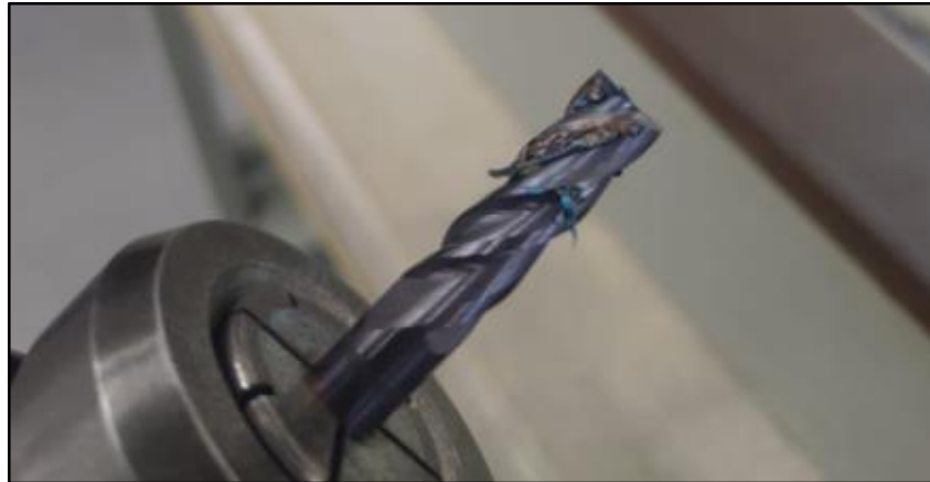
Figura 32 - Fim de Vida por Entupimento de Canais
