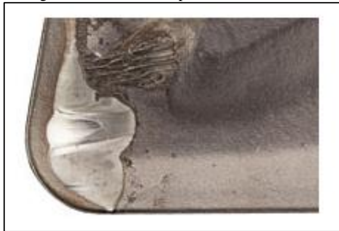
Figura 10 – Cratera em pastilha de fresamento
