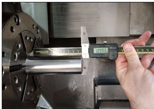
Figura 3.15 - Corpo de Prova posicionado para usinagem
