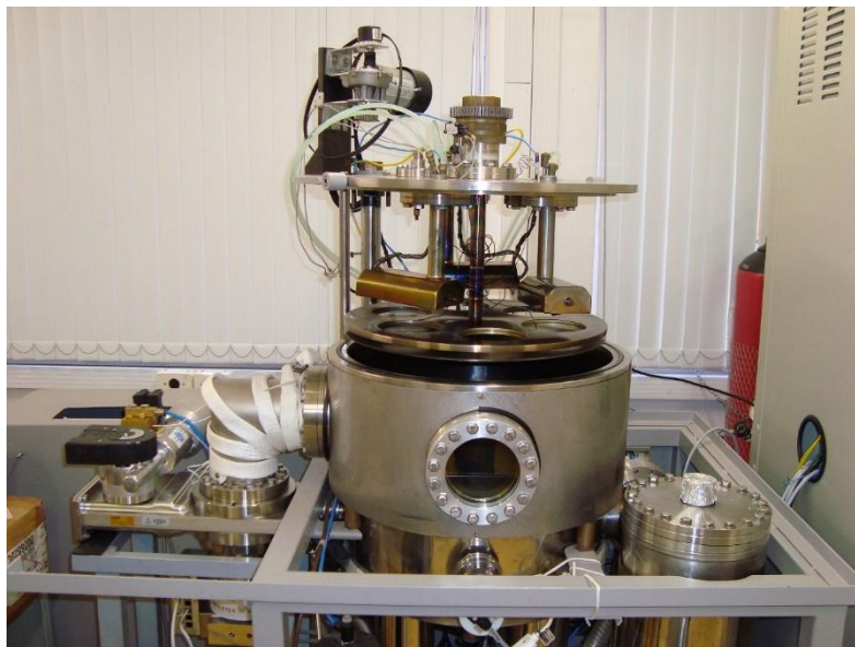
Figura 8: magnetron sputtering localizado no LESTT I – UCS.
