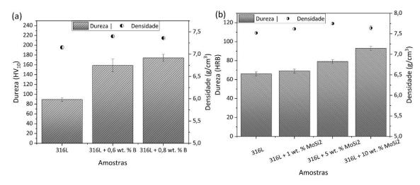
Figura 2.24 — Dureza e densidade para aços inoxidáveis austeníticos com adição de (a) B [12] e (b)  $MoSi_2$  [24]
