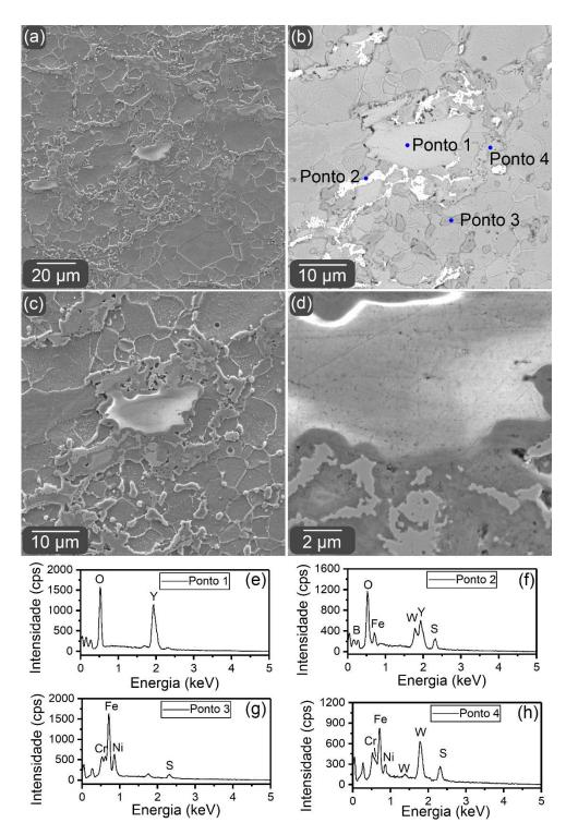
Figura 4.10 — Microestrutura da amostra 316L-BW. Imagens da morfologia obtida por MEV-FEG com o uso de elétrons [(a), (b) e (d)] secundários e [(c))] restroespalhados. [(e)-(h)] Composição química obtida por EDS
