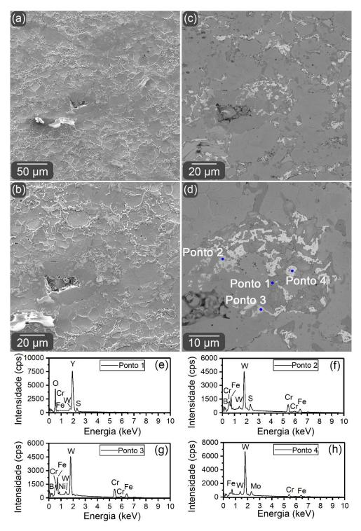
Figura 4.11 — Microestrutura da amostra 316L-BYW. Imagens da morfologia obtida por MEV-FEG com o uso de elétrons [(a) e (c)] secundários e [(b) e (d)] restroespalhados. [(e)-(h)] Composição química obtida por EDS.
