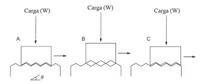
Figura 2.9 — Modelo de Coulomb como mecanismo de atrito. Adaptado de [14].
