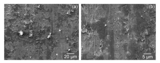
Figura 4.24 — Superfície desgastada da amostra 316L-8W.
