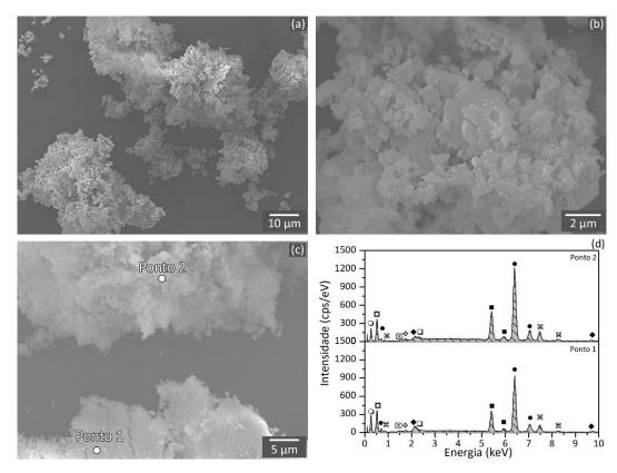
Figura 4.32 — Partículas de desgaste (debris) do ensaio de deslizamento com a amostra 316L-02B. Em (d),  $\square$  é Mo,  $\spadesuit$  é Au,  $\square$  é O,  $\bullet$  é Fe,  $\Re$  é Ni,  $\boxtimes$  Al,  $\diamondsuit$ •é Si,  $\blacksquare$  é Cr e  $\bigcirc$  é C.
