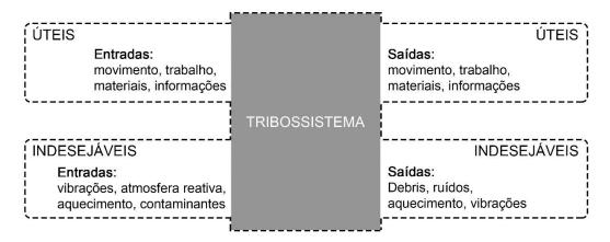
Figura 2.4 — Tribossistema descrito de forma funcional e geral como um sistema com entradas e saídas úteis e indesejáveis. Adaptado de [37].
