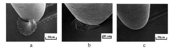
Figura 2.18 — Modos de desgaste abrasivo em superfícies dúcteis. (a) Microcorte, (b) formação de cunha e (c) sulcamento. Adaptado de [61].
