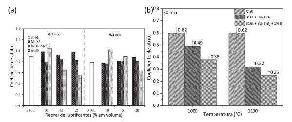
Figura 2.26 — Coeficiente de atrito para sistema compostos por aços inoxidáveis austeníticos com diferentes lubrificantes sólidos. (a)  $MoS_2$  e h-BN, adaptado de [9]. (b)  $TiB_2$  e B, adaptado de [11].
