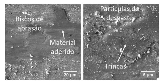
Figura 2.13 — Superfície de um aço inoxidável austenítico com diversas características de desgaste. Magnificação de (a) 200 X e (b) 1000 X. Adaptado de [12].
