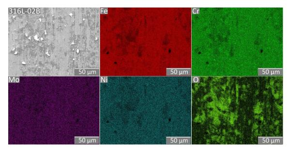
Figura 4.27 — Mapeamento química por EDS da superfície desgastada da amostra 316L-02B.
