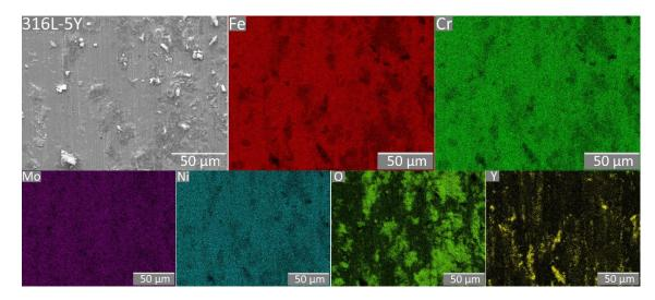
Figura 4.28 — Mapeamento química por EDS da superfície desgastada da amostra 316L-5Y.
