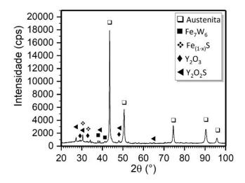
Figura 4.14 — Difratograma da amostra 316L-BYW, em que se observa os picos das fases austenita,  $Fe_7W_6$ ,  $Fe_{(1-x)}$ ,  $Y_2O_3$  e  $Y_2O_2S$
