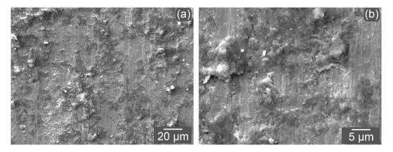
Figura 4.25 — Superfície desgastada da amostra 316L-BYW.
