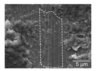
Figura 4.36 — Riscos de abrasão na superfície desgastada da amostra 316L-5Y.
