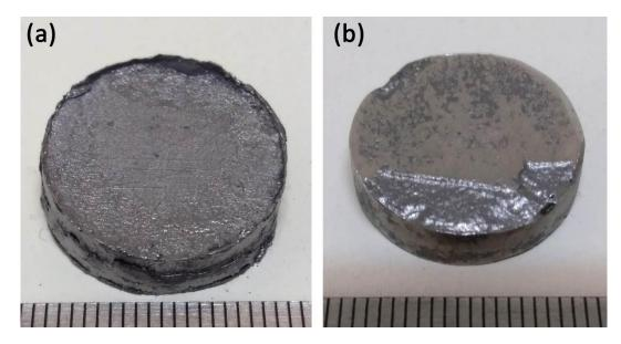
Figura 3.5 — Amostra 316L-02B (a) ao ser extraída da matriz de carbono e (b) após limpeza superficial
