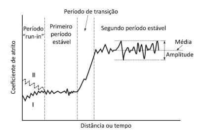
Figura 2.11 — Transições do atrito em função da distância ou tempo em superfícies sob deslizamento. Adaptado de [36]
