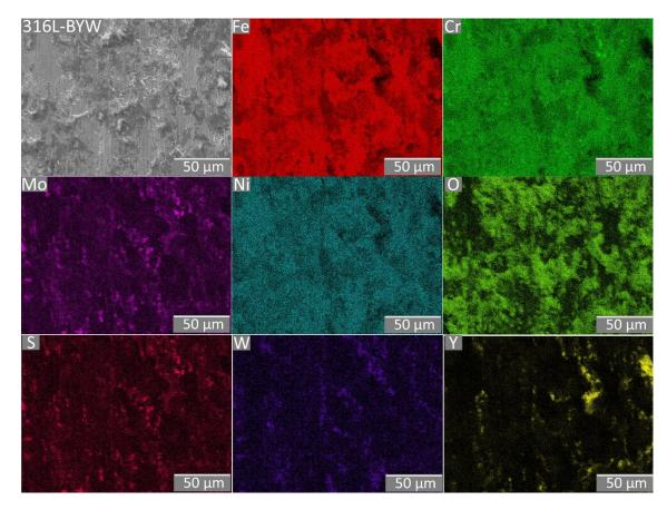
Figura 4.30 — Mapeamento química por EDS da superfície desgastada da amostra 316L-BYW.
