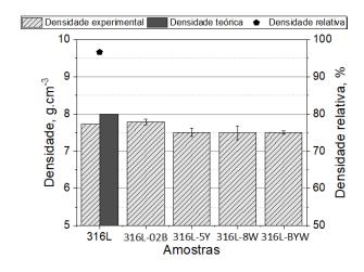
Figura 4.15 — Densidades real, teórica e relativa dos materiais sinterizados
