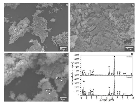
Figura 4.35 — Partículas de desgaste (debris) do ensaio de deslizamento com a amostra 316L-BYW. Em (d),  $\square$  é Mo,  $\spadesuit$  é Au,  $\square$  é O,  $\bullet$  é Fe,  $\aleph$  é Ni,  $\boxtimes$  Al,  $\diamondsuit$  é Si,  $\blacksquare$  é Cr,  $\bigcirc$  é C, + é Y,  $\blacktriangledown$  é W e  $\blacktriangle$  é S.
