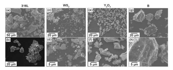
Figura 3.2 — Morfologia das partículas das matérias primas utilizadas na produção das amostras do trabalho
