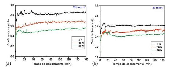
Figura 2.8 — Coeficiente de atrito em função do tempo e da carga aplicada em ensaios com velocidade de deslizamento de (a) 20 e (c) 30 mm·s<sup>-1</sup>. Adaptado de [40].
