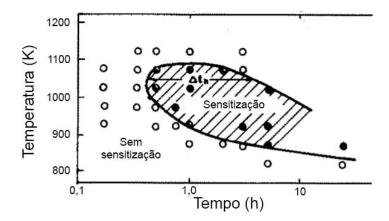
Figura 2.3 — Curva de resfriamento contínuo do aço inoxidável 316. Adaptado de [34].
