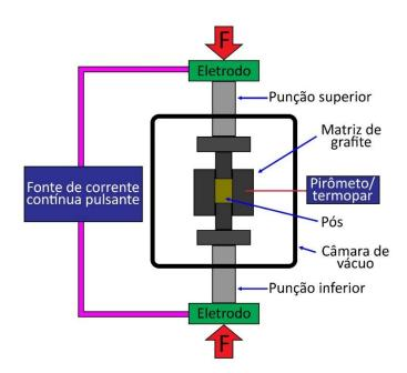
Figura 2.23 — Representação esquemática de um equipamento de SPS. Adaptado de: [25].
