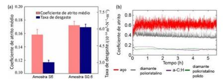
Figura 2.20 — (a) Coeficiente de atrito para compósitos de Cu com adição de MoS₂ com diferentes tamanhos de partículas, adaptado de [62]. (b) Coeficiente de atrito em função do tempo para diferentes revestimentos a base de carbono, adaptado de[63].
