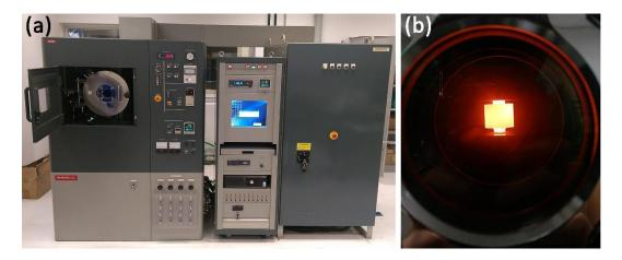
Figura 3.3 — (a) SPS modelo DR. SINTER SPS 1050, presente no LMO-USP; (b) matriz de carbono a 1000 °C durante o processo de sinterização
