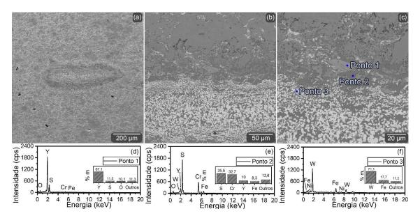
Figura 4.12 — Microestrutura da amostra 316L-BYW em região com grandes aglomerados de fases formadas ricas em W e S provenientes da decomposição do WS<sub>2</sub>. Imagens da morfologia obtida por MEV-FEG com o uso de elétrons [(a)] secundários e [(b) e (c)] restroespalhados. [(d)-(f)] Composição química obtida por EDS.
