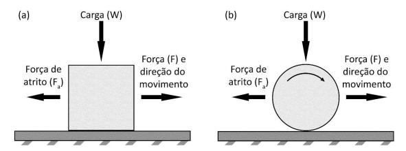
Figura 2.6 — Forças aplicadas em um sólido em movimento relativo de (a) deslizamento e (b) rolamento. Adaptado de [36].
