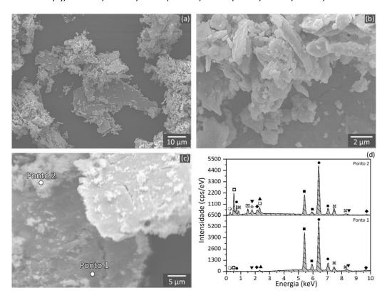
Figura 4.34 — Partículas de desgaste (debris) do ensaio de deslizamento com a amostra 316L-8W. Em (d), □ é Mo, ◆ é Au, □ é O, ● é Fe, ૠ é Ni, ☒ Al, ❖·é Si, ■ é Cr, ○ é C, ▼é W e ▲ é S.
