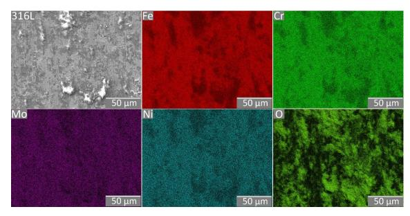
Figura 4.26 — Mapeamento química por EDS da superfície desgastada da amostra 316L.
