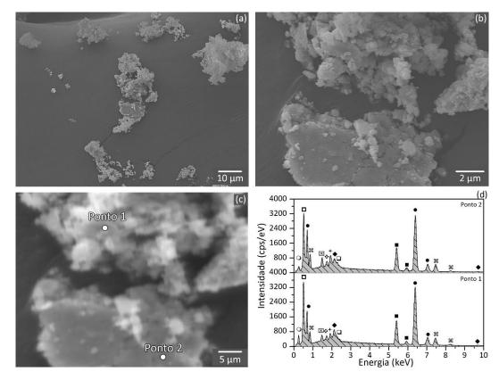
Figura 4.33 — Partículas de desgaste (debris) do ensaio de deslizamento com a amostra 316L-5Y. Em (d),  $\square$  é Mo,  $\spadesuit$  é Au,  $\square$  é O,  $\bullet$  é Fe,  $\Re$  é Ni,  $\boxtimes$  Al,  $\diamondsuit$ •é Si,  $\blacksquare$  é Cr,  $\bigcirc$  é C e + é Y.
