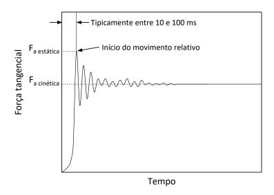
Figura 2.7 — Forças tangenciais em função do tempo em um sistema com superfícies em movimento relativo. Adaptado de [36].
