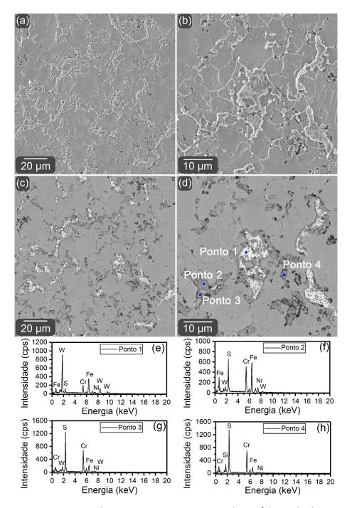
Figura 4.7 —Microestrutura da amostra 316L-8W. Imagens da morfologia obtida por MEV-FEG com o uso de elétrons [(a) e (b)] secundários e [(c) e (d)] restroespalhados. [(e)-(h)] Composição química obtida por EDS.
