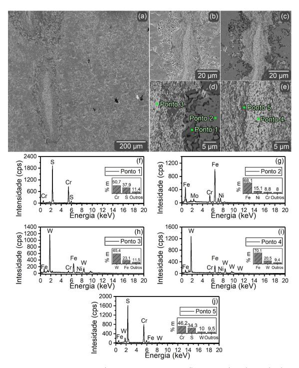
Figura 4.8 — Microestrutura da amostra 316L-8W em região com grandes aglomerados de fases formadas ricas em W e S provenientes da decomposição do WS<sub>2</sub>. Imagens da morfologia obtida por MEV-FEG com o uso de elétrons [(a) e (b)] secundários e [(c)-(d)] restroespalhados. [(f)-(j)] Composição química obtida por EDS.
