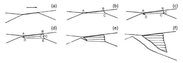
Figura 2.16 — Esquema que representa a teoria de Kayaba e Kato para o desgaste adesivo de duas superfícies sob deslizamento. Adaptado de [60].
