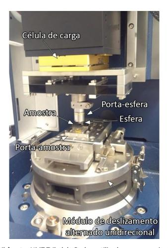
Figura 3.8 — Tribômetro UMT Tribolab, Bruker, utilizado para o ensaio de deslizamento alternado unidirecional a seco
