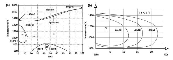
Figura 2.2 — (a) Diagrama de fase Fe-Cr, adaptado de [32]. (b) Detalhe do campo da austenita do diagrama de fase Fe-Cr com diferentes teores de Ni, adaptado de [33].
