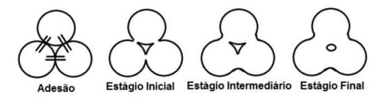
Figura 2.22 — Estágios da sinterização de pós. Adaptado de [68].
