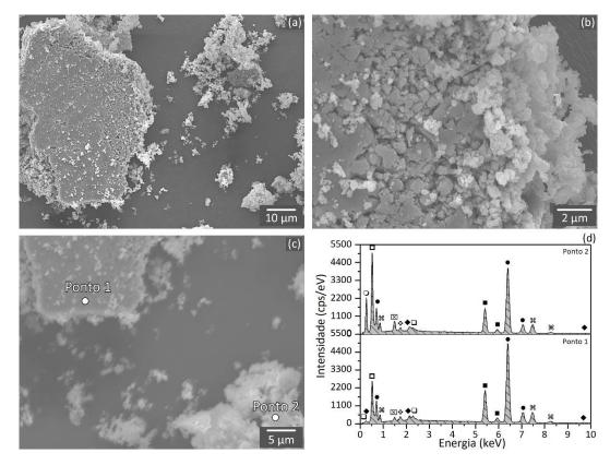
Figura 4.31 — Partículas de desgaste (debris) do ensaio de deslizamento com a amostra 316L.  $Em(d), \square$  é  $Mo, \spadesuit$  é  $Au, \square$  é  $O, \blacksquare$  é  $Fe, \Re$  é  $Ni, \boxtimes Al, \diamondsuit \cdot$  é  $Si, \blacksquare$  é Cr e  $\bigcirc$  é C.
