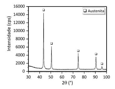
Figura 4.2 — Difratograma da amostra 316L, em que se observa os picos da fase austenita.
