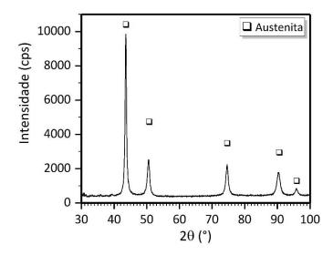
Figura 4.4 — Difratograma da amostra 316L-02B, em que se observa os picos da fase austenita.
