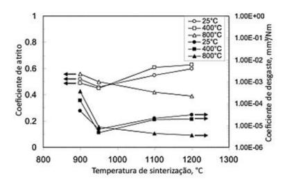
Figura 2.21 — Coeficientes de atrito e taxa de desgaste para amostras de  $Zr_2O_3(Y_2O_3)$  + 35%CaF<sub>2</sub> + 30% em massa de Ag sinterizadas e submetida a testes de deslizamento a diferentes temperaturas. Adaptado de [64].
