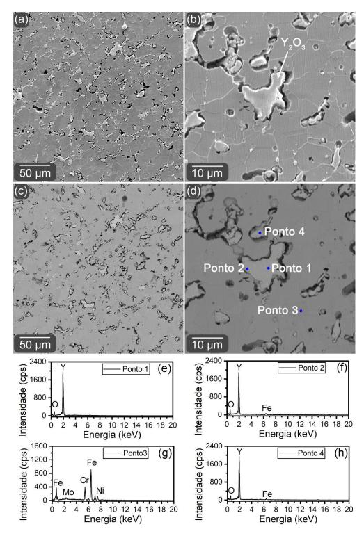
Figura 4.5 — Microestrutura da amostra 316L-5Y. Imagens da morfologia obtida por MEV-FEG com o uso de elétrons [(a) e (b)] secundários e [(c) e (d)] restroespalhados. [(e)-(h)] Composição química obtida por EDS.
