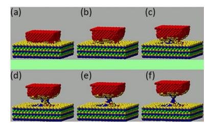
Figura 2.10 — As imagens de (a) a (f) mostram a adesão de átomos de ouro no penetrador de cobre e a formação progressiva de um pescoço de ouro enquanto o penetrador é levantado da superfície [49]. Adaptado de [14].
