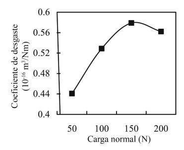
Figura 2.14 — Coeficiente de desgaste em função da carga normal para um tribossistema composto por um corpo cerâmico e um contracorpo metálico. Adaptado de [53].
