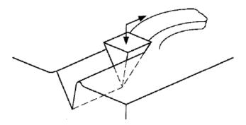
Figura 2.17 — Desgaste abrasivo de uma superfície dúctil. Adaptado de [61].
