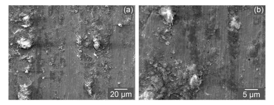
Figura 4.22— Superfície desgastada da amostra 316L-02B.
