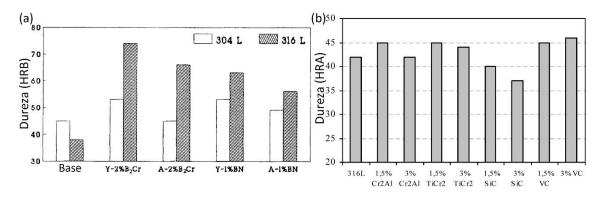
Figura 2.25 — Dureza para sistema compostos por aços inoxidáveis austeníticos com diferentes reforços mecânicos. (a)  $Y_2O_3$  e  $Al_2O_3$ , adaptado de[13]. (b) intermetálicos, adaptado de [18].
