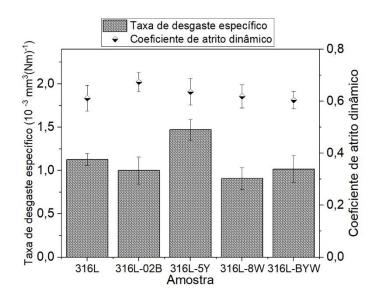
Figura 4.19 — Valores médios do coeficiente de atrito e da taxa de desgaste específica das amostras.
