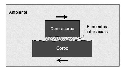
Figura 2.5 — Elementos de um tribossistema. Adaptado de [37].
