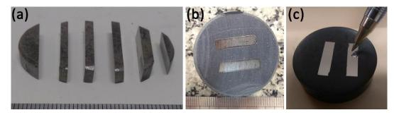
Figura 3.6 — (a) amostra 316L-BYW cortada; (b) amostra 316L-8W embutida; (c) amostra 316L-5Y polida.
