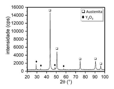
Figura 4.6 — Difratograma da amostra 316L-5Y, em que se observa os picos das fases austenita e  $Y_2O_3$ .
