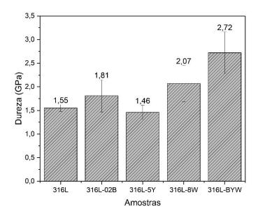
Figura 4.16 — Dureza dos materiais sinterizados com diferentes aditivos.
