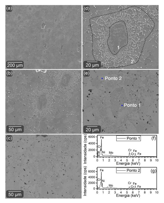
Figura 4.3 — Microestrutura da amostra 316L-02B. Imagens da microestrutura obtida por MEV-FEG com o uso de elétrons [(a), (b) e (d)] secundários e [(c) e (e)] restroespalhados. [(f) e (g)] Composição química obtida por EDS. Em (d), a região 1 é a região grande e elíptica e a região 2 é a região com formato semelhante a fibras.
