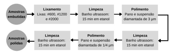
Figura 3.7 — Fluxograma das etapas de lixamento e polimento das amostras
