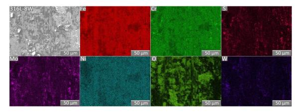
Figura 4.29 — Mapeamento química por EDS da superfície desgastada da amostra 316L-8W.
