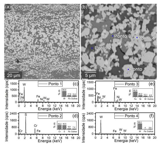
Figura 4.13 — Microestrutura da amostra 316L-BYW em no interior da região com grandes aglomerados de partículas de WS<sub>2</sub>. Imagens da morfologia obtida por MEV-FEG com o uso de elétrons [(a) e (b)] restroespalhados. [(c)-(f)] Composição química obtida por EDS.
