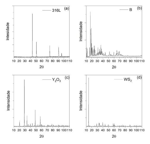
Figura 3.1 — Difratograma dos pós utilizados como matéria-prima para produção das amostras deste trabalho.
