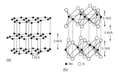
Figura 2.19 — Estrutura cristalina lamelar do (a) grafite e do (b) MoS<sub>2</sub>. Adaptado de [14].
