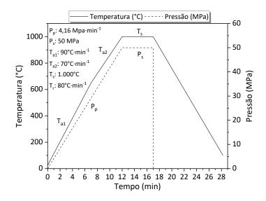
Figura 3.4 — Taxas de aquecimento, resfriamento e pressurização além da temperatura e pressão de sinterização ajustados no controlador do SPS.
