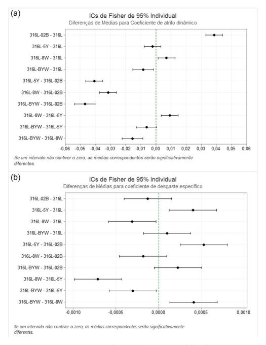
Figura 4.20 — Teste de Fisher para verificar se a hipótese de os (a) coeficientes de atrito e (b) as taxas de desgaste das amostras 316L, 316L-B, 316L-5Y, 316L-8W e 316L-BYW serem iguais.
