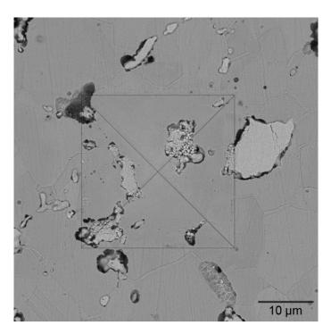
Figura 4.17 — Indentação piramidal de ensaio de macrodureza Vickers na amostra 316L-5Y.
