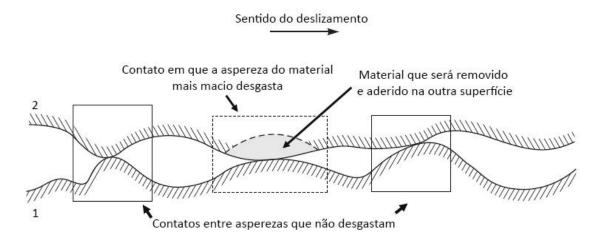
Figura 2.15 — Esquema que representa a teoria de Archard para o desgaste adesivo de duas superfícies (em que 1 é mais dura que 2) sob deslizamento. Adaptado de [36].
