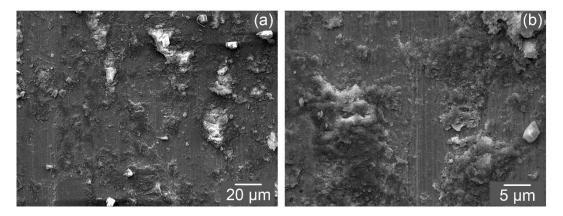
Figura 4.23— Superfície desgastada da amostra 316L-5Y.
