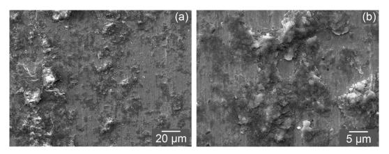
Figura 4.21 — Superfície desgastada da amostra 316L.
