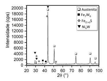
Figura 4.9 — Difratograma da amostra 316L-8W, em que se observa os picos da fase austenita,  $Fe_7W_6$ ,  $Fe_{(1-x)}S$  e  $Ni_4W$
