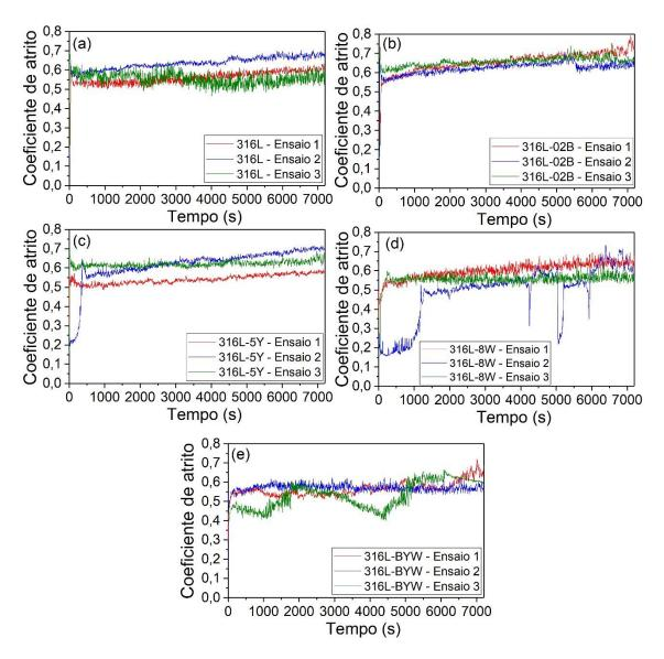
Figura 4.18 — Coeficiente de atrito em função do tempo para três ensaios nas amostras (a) 316L, (b) 316L-02B, (c) 316L-5Y, (d) 316L-8W e (e) 316L-BYW.
