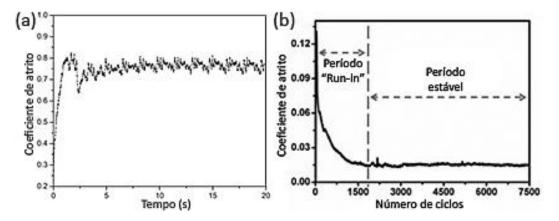
Figura 2.12 — Diferentes durações de cada tipo período de atrito para diferentes tribossistemas. (a) Adaptado de [50]. (b) Adaptado de [51].
