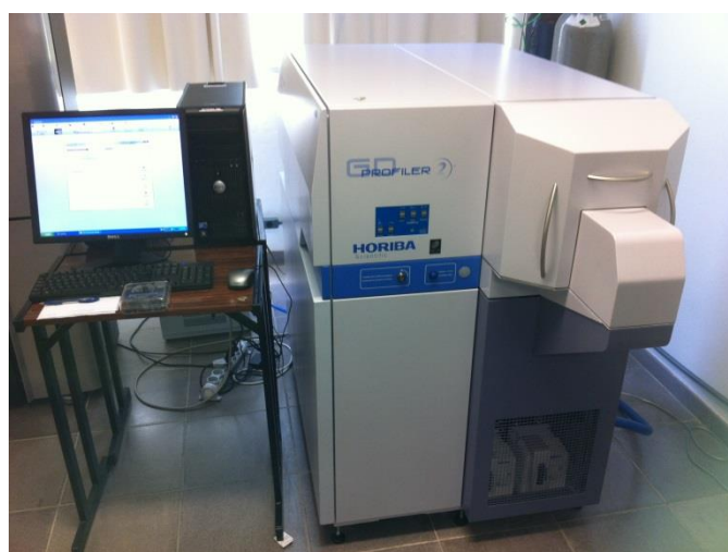
Figura 13: GD-OES instalado no LACASUNE da UCS
