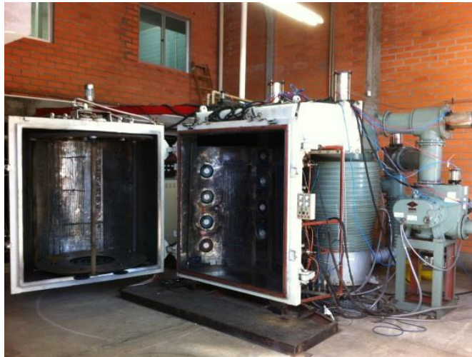
Figura 12: Equipamento para deposição de filmes de TiN
