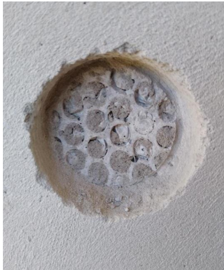
Figura 29: Falha no substrato plástico bolha
