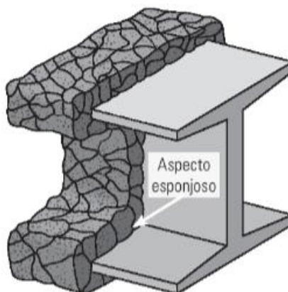
Figura 11 - Proteção tipo tinta intumescente
