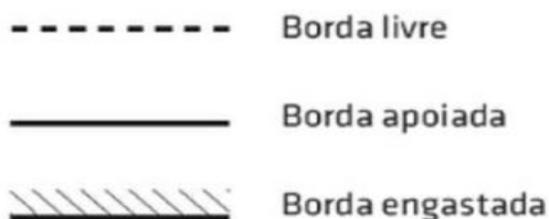
Figura 5 – Simbologia para condições de apoio.
