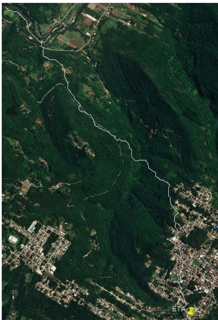
Figura 35 – Traçado de mínimo custo com ponto de captação superficial no estudo
