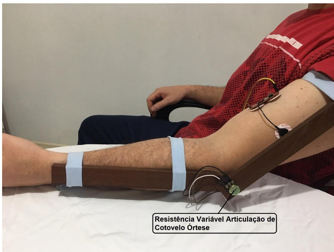
Figura 23 – Esboço Órtese com Leitura de Posição Angular de Cotovelo em Posição Inicial ou de Repouso do MS
