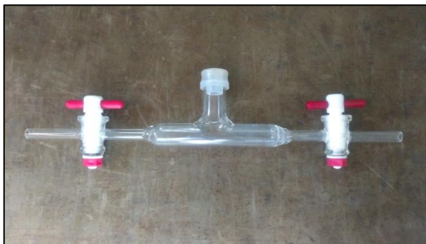
Figura 7 - Coletor de gás ( trap ) utilizado na gaseificação (Autor).
