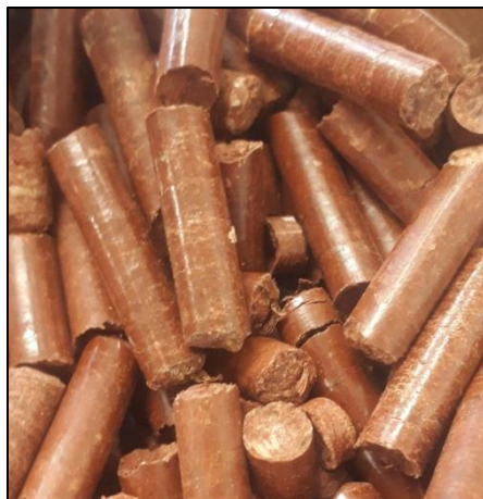
Figura 5 - Pellets de capim elefante com a adição do óxido de Ferro (Autor).
