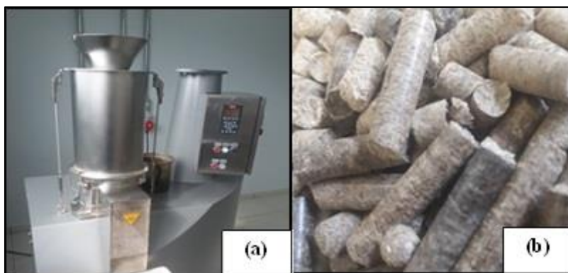
Figura 4 - Peletizadora Amandhus Kahl(a) e os pellets de capim elefante(b) (Autor).
