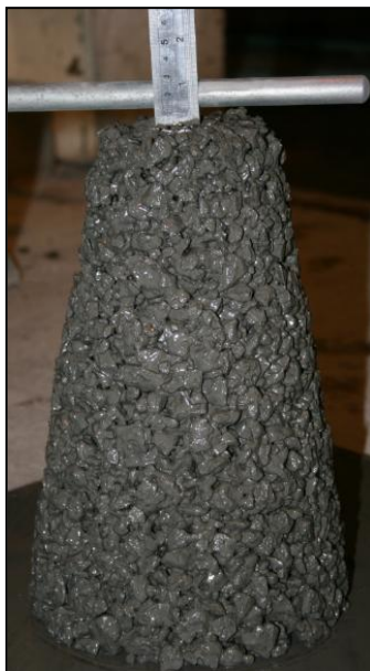
Figura 22 - Resultado do ensaio de abatimento de tronco de cone de cone do CR (Fonte: o autor).
