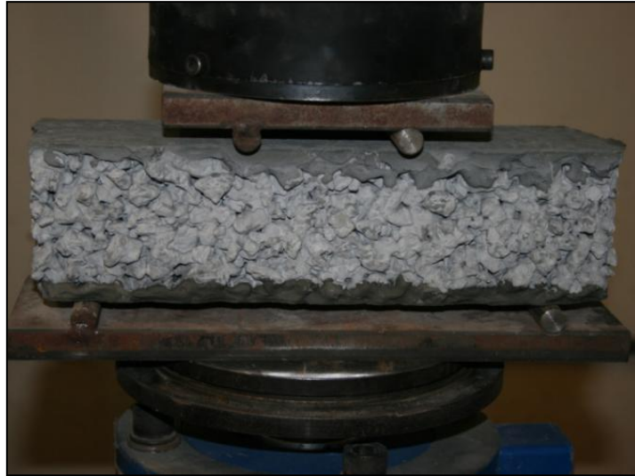
Figura 24 - Resistência à tração na flexão do concreto permeável referência em molde prismático com 28 dias de idade (Fonte: o autor).
