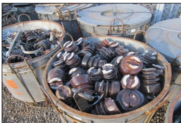
Figura 4 - Resíduos de isoladores elétricos de porcelana na Estação Avançada de Vacaria – RS.
