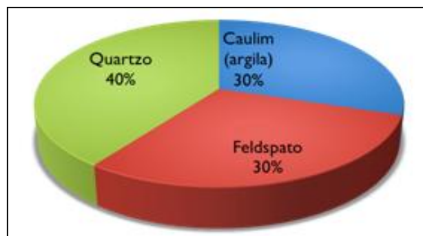
Figura 2 - Composição dos isoladores elétricos de porcelana (MAMEDE FILHO, 1994).
