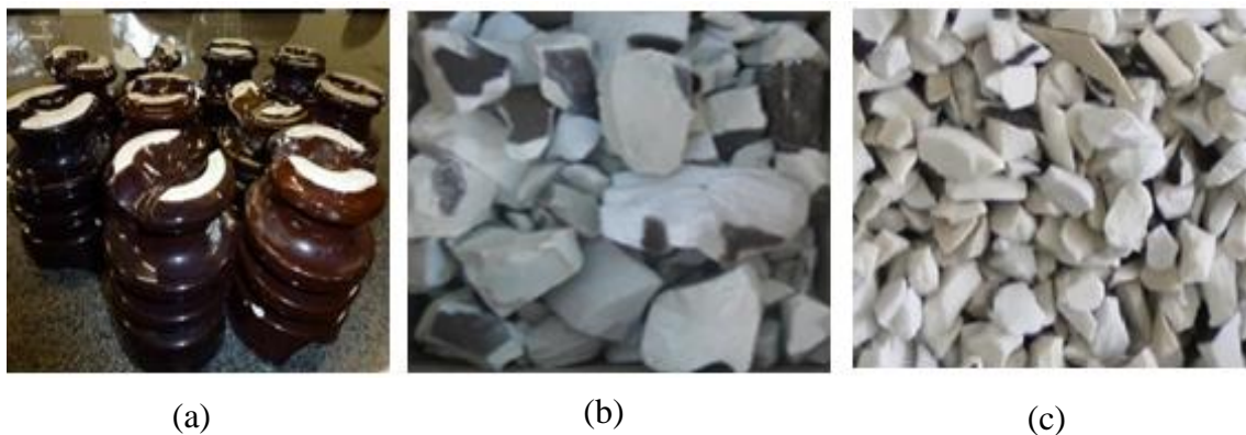
Figura 14 - Resíduos de isoladores elétricos de porcelana (a) antes do processo de cominuição (b) antes do processo de cominuição com dimensões de partículas e (c) antes do processo de cominuição com dimensões de partículas.
