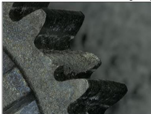
Figura 9 – Fratura do dente de uma engrenagem.
