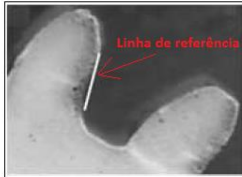
Figura 11 – Dano devido à redução de espessura no dente.
