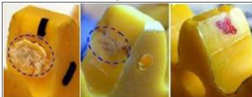
Figura 12 – Dano devido às altas temperaturas na face de contato entre os dentes.
