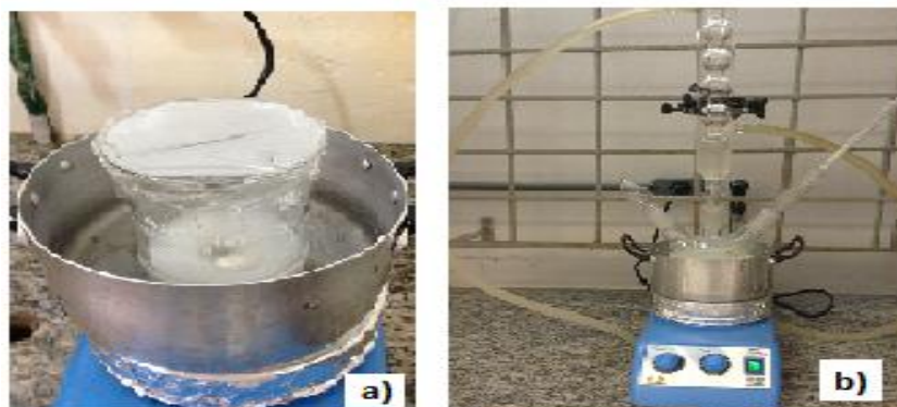
Figura 14 - Hidrólise ácida da polpa kraft Eucalyptus a) sob agitação b) sistema de refluxo.
