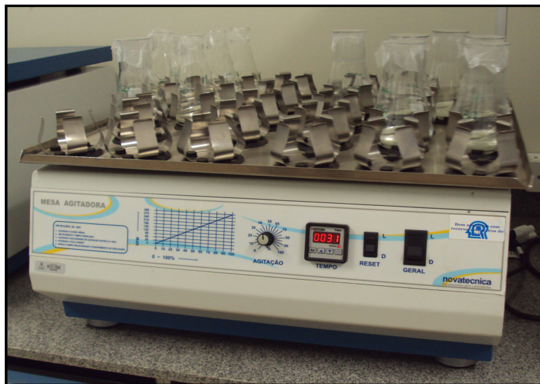
Figura 9. Mesa orbital utilizada no ensaio com o efluente industrial.
