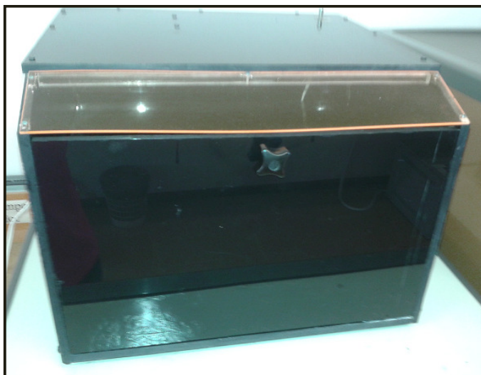
Figura 10. Cabine de raios UV utilizada no ensaio com o efluente industrial.
