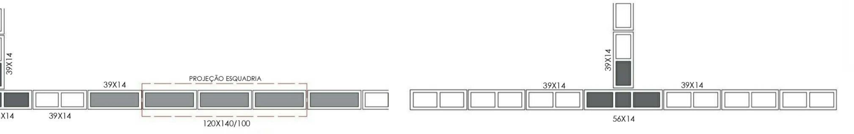
SEÇÃO PAREDE (L) + VERGA PARA ESQUADRIAS BLOCO ALOJAMENTO OS CANTOS EXTERNOS, ENCONTROS DE PAREDES EM L SÃO GRAUTEADOS PERMITINDO A RIGIDEZ DO CONJUNTO. ALÉM DISSO AS VERGAS E CONTRA-VERGAS ESTABELECIDAS PELOS BLOCOS CAHALETAS PERMITEM UMA MELHOR FUNCIONAMENTO NA SUSTENTAÇÃO DAS ESQUADRIAS.
