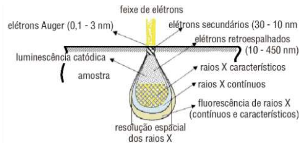
Figura 29: Volume de interação: localização dos sinais emitidos pela amostra. Adaptado de [94].
