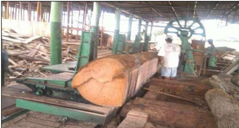
Figura 18 – Rolos de transporte da madeira
