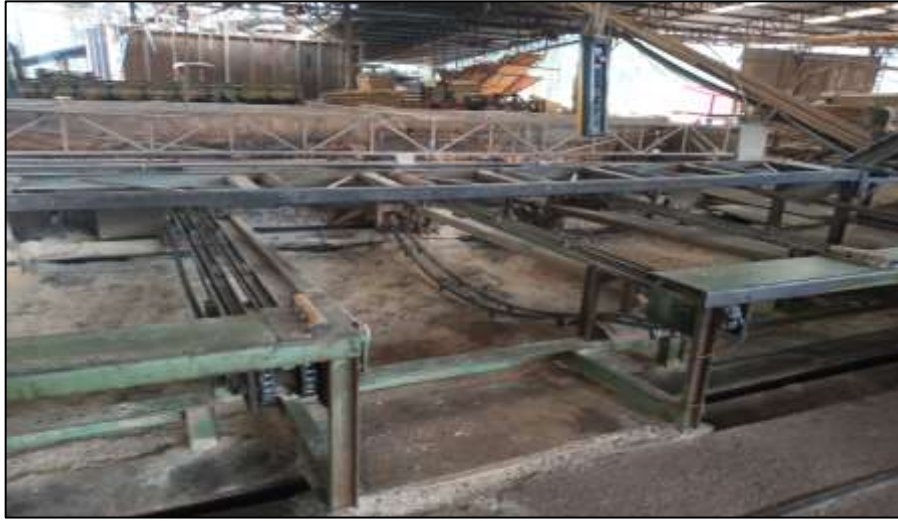
Figura 21 – Esteira do destopamento
