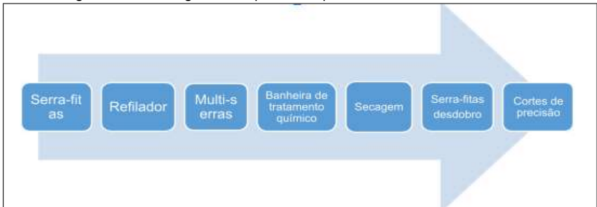
Figura 12 – Fluxograma do processo produtivo da Madeireira Miotto
