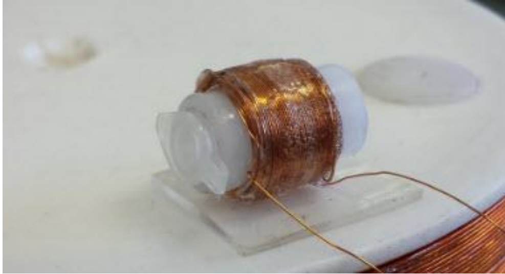
Figura 28. Pick-up coil para análise de frequência de ressonância em meio líquido, suportando Eppendorf de 250 \mu\text{L} (o autor).
