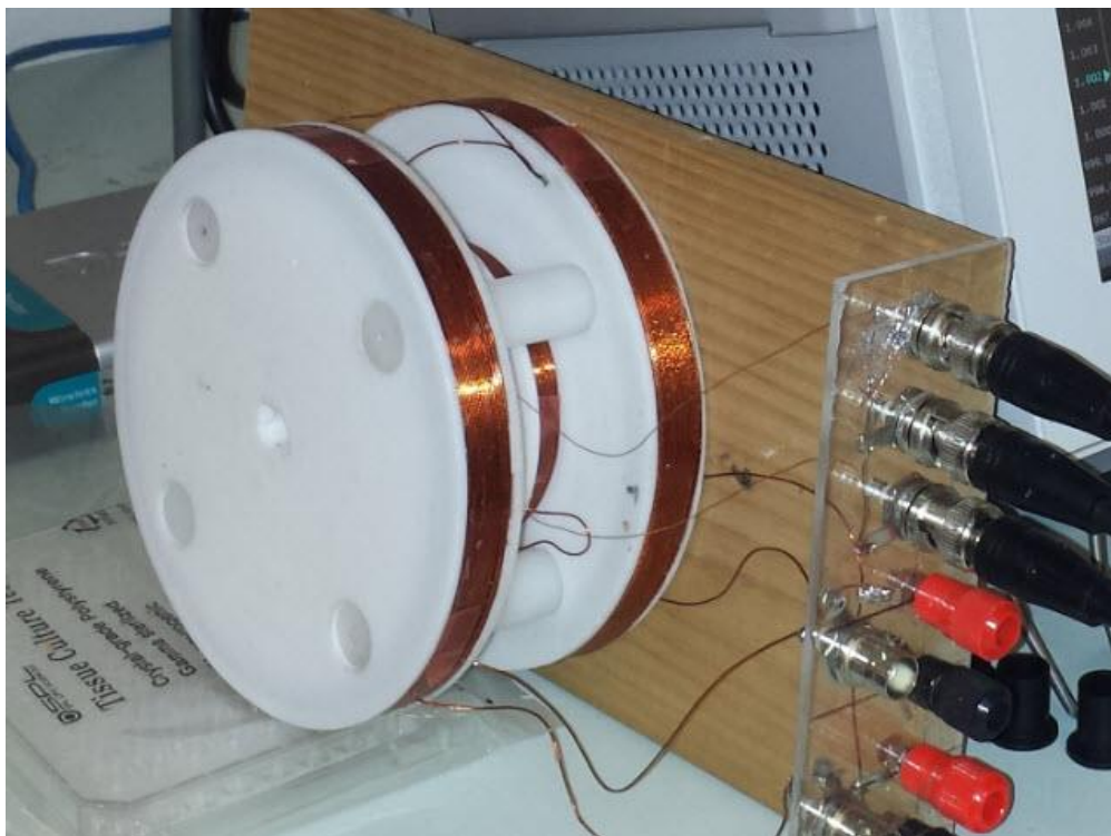
Figura 27. Bobina de Helmholtz para leitura de sensores usando Lock-in e fonte (o autor).
