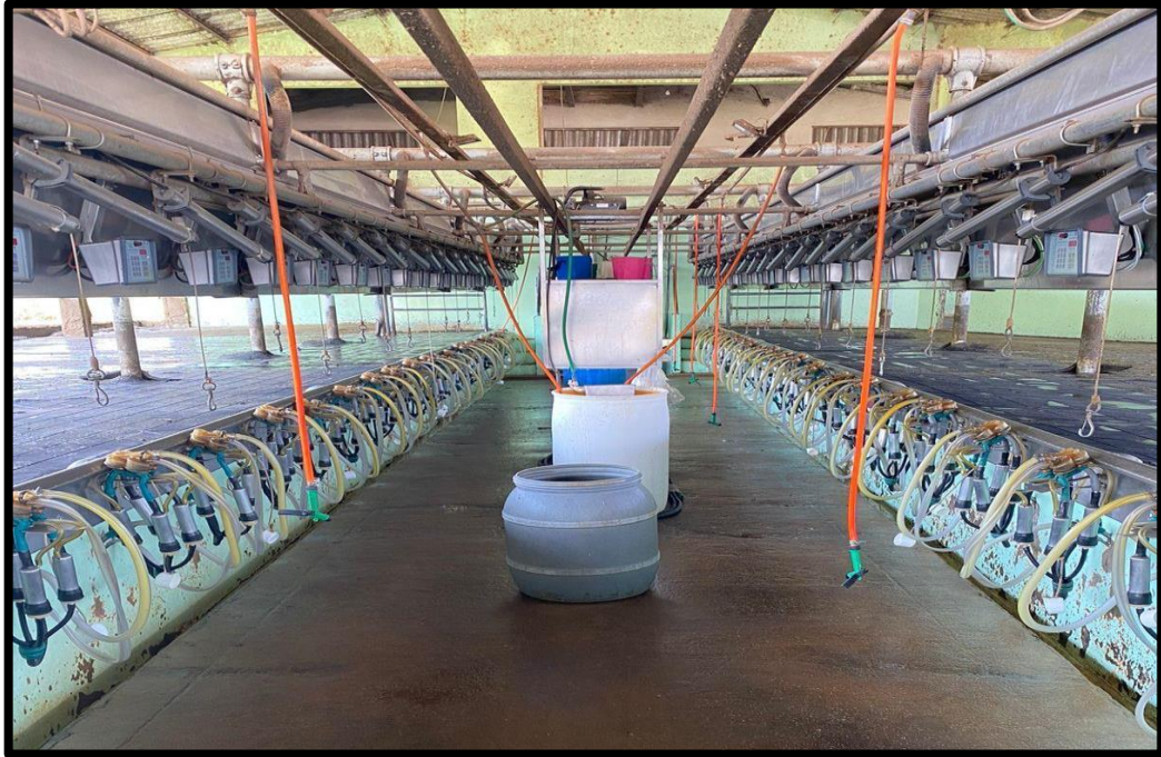
Figura 2 – Sistema de ordenha side-by-side .
