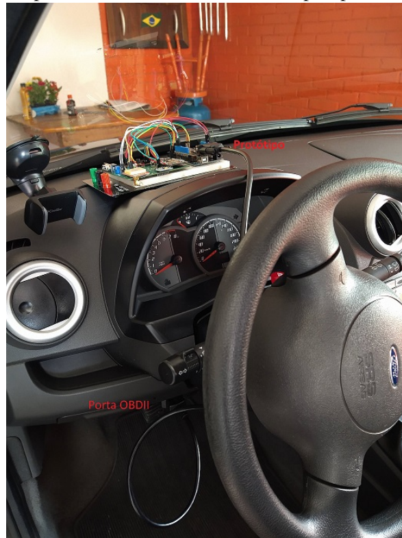
Figura 26 – Protótipo montado no veículo Ford Ka Sport para teste de integração.
