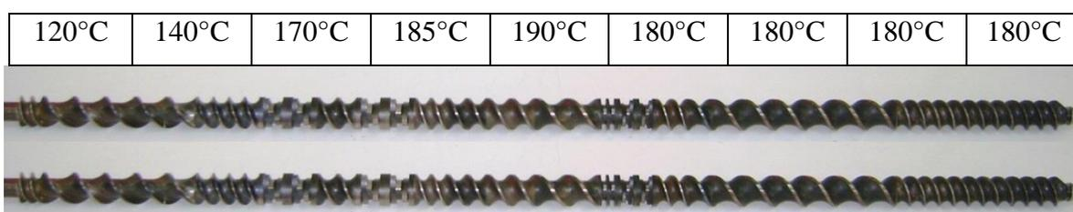
**Figura 13:** Perfil de rosca (L/D 46) utilizado na obtenção de compósitos com as temperaturas respectivas das zonas 1 a 9, e a temperatura da matriz 180°C.
