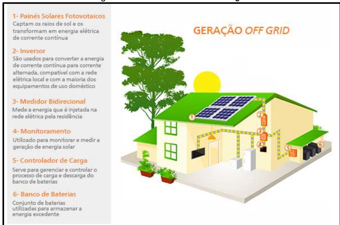
Figura 32 - Sistema isolado ou off-grid
