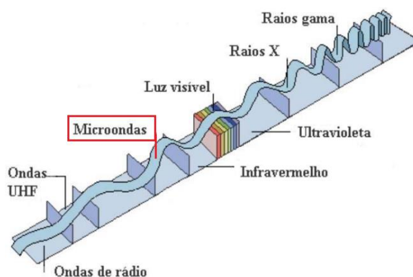
Figura 6: Localização da região de micro-ondas no espectro eletromagnético.
