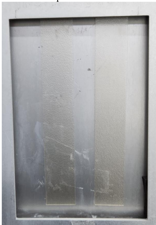
Figura 41 – Corpos de prova afixados no suporte antes do ensaio de exposição ao intemperismo acelerado
