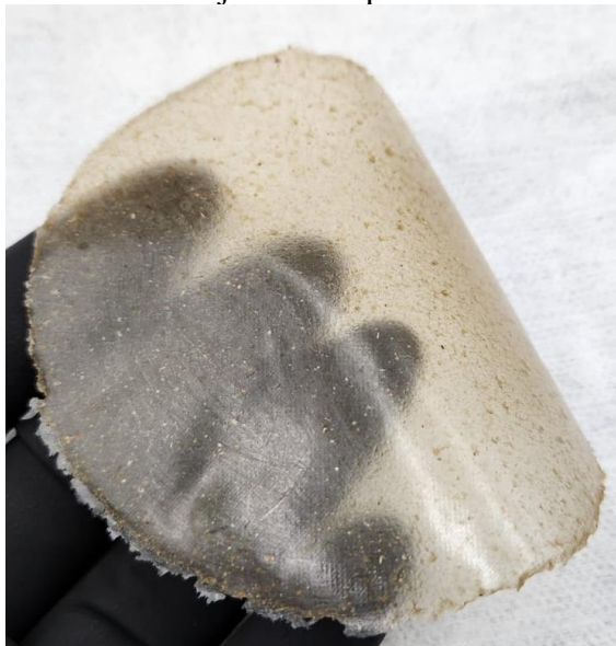
Figura 15 – Filme produzido com ajustes nos parâmetros de secagem e concentração
