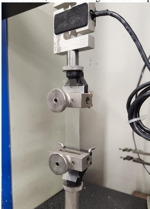
Figura 12 – Filme sendo tracionado, afixado nas garras da máquina universal de ensaios
