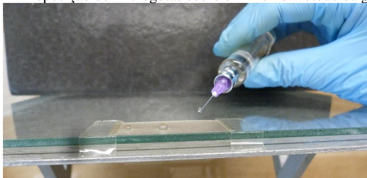
Figura 11 – Deposição de microgotas sobre o filme no método da gota séssil
